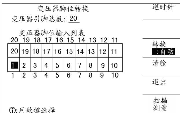
图 5-2 20 路变压器脚位转换界面
