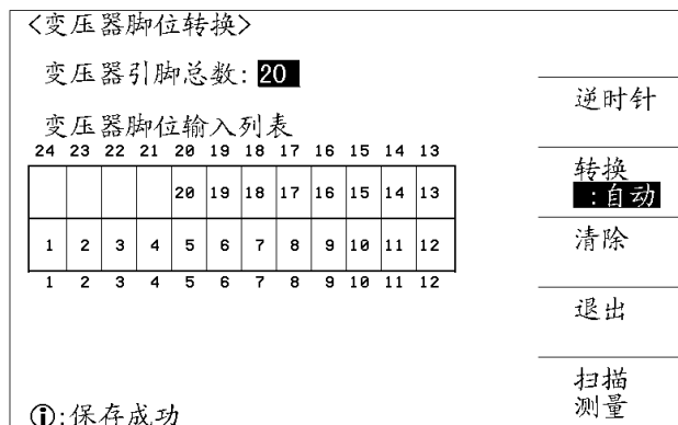
图 5-3 24 路变压器脚位转换界面
